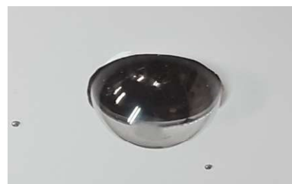
水中部カメラドーム
