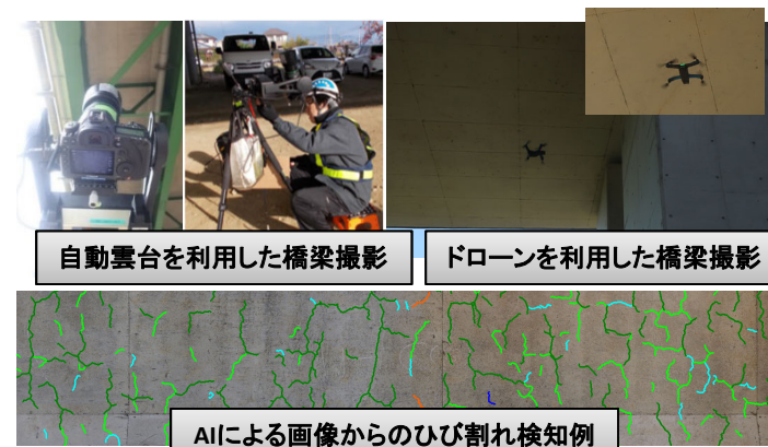
AIによる画像からのひび割れ検知例
