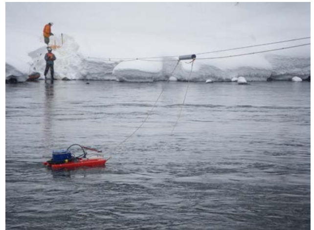
<河川流量測定状況>
