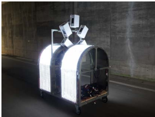
BOX カルバート（台車に機材搭載）
