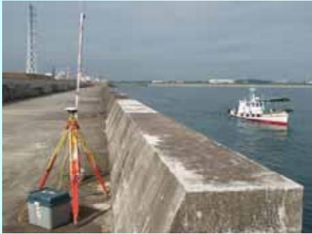
GPS受信機(固定局)および測量船の航行状況
